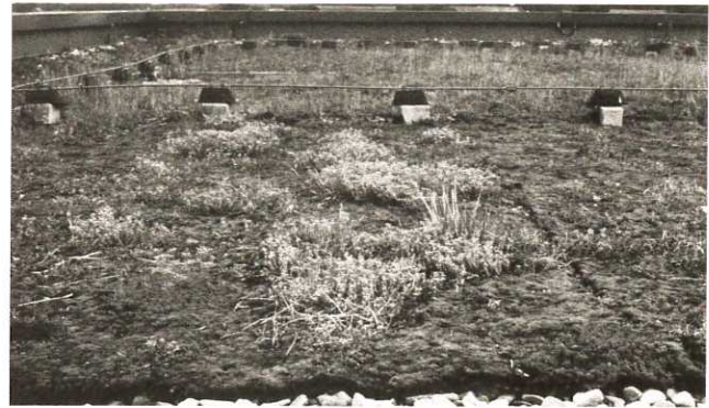
Abb. 2: Versuchsanlage zur Erprobung vegetationstechnischer Extensivbegrünungen. Im Vordergrund vorkultivierte Vegetationsmatten mit Moos-Sedum-Vegetation auf Kies verlegt.
